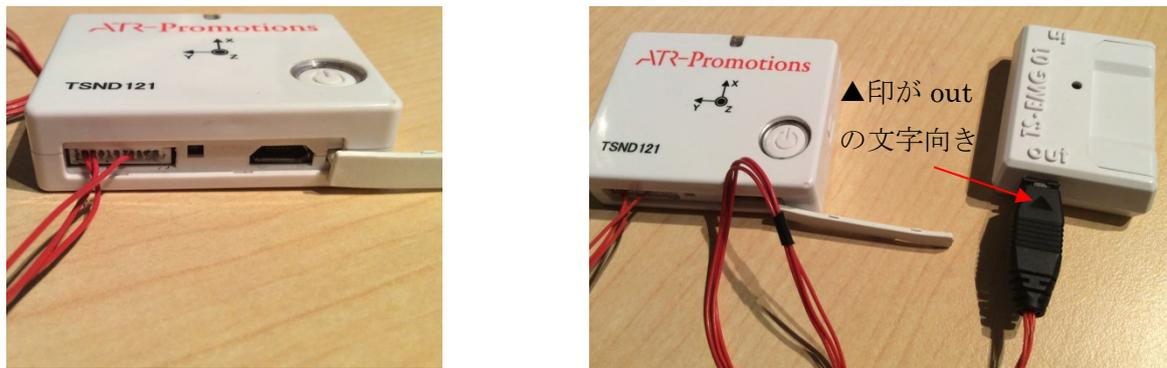
アナログ出力ケーブルの反対側を生体アンプ out 部分に差し込む
